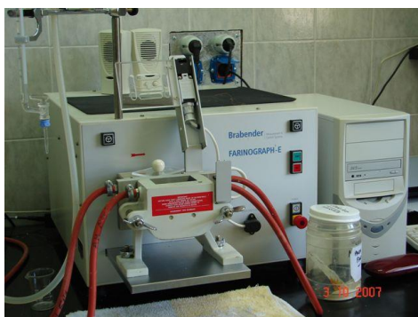
Fig. 1 – a) Farinógrafo ; b) Farinograma típico de uma farinha forte.
